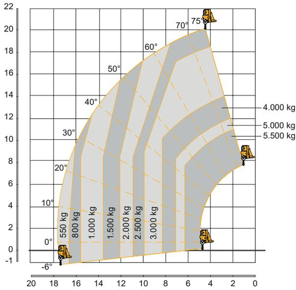
Drehung auf ausgefahrenen Stützen
